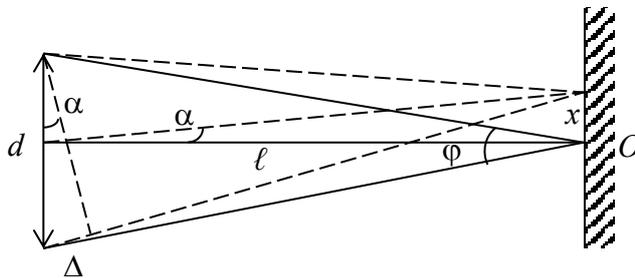
Пусть точка  $O$  – центр интерференционной картины. При смещении на  $x$  вдоль экрана между лучами появляется разность хода  $\Delta$ . Из рисунка видно, что  $\Delta = d\alpha$ , а разность фаз  $\delta = \frac{2\pi}{\lambda}\Delta = \frac{2\pi}{\lambda}d\alpha$ .
