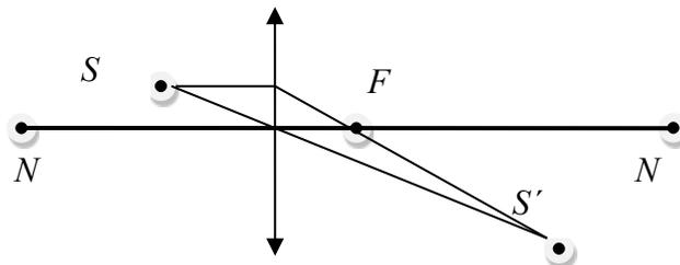
Третий луч за линзой идет параллельно главной оптической оси через точку изображения, а перед линзой проходит через фокус (и точку предмета).
