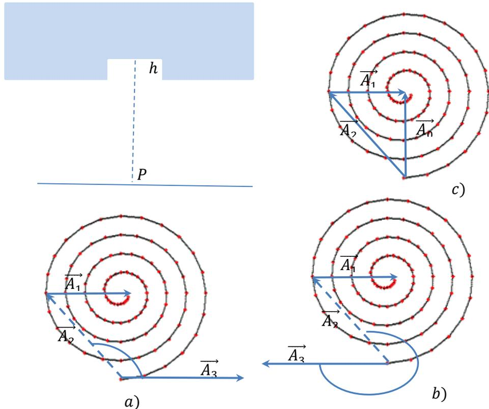
оптические пути. Следовательно, между ними появится дополнительная оптическая разность хода  $\Delta = h(n - 1)$  и соответствующая разность фаз, величина которой зависит от глубины выемки  $h$ . Таким образом, вектор  $A_2$ , изображающий результирующее колебание от полутора зон, развернётся на угол
