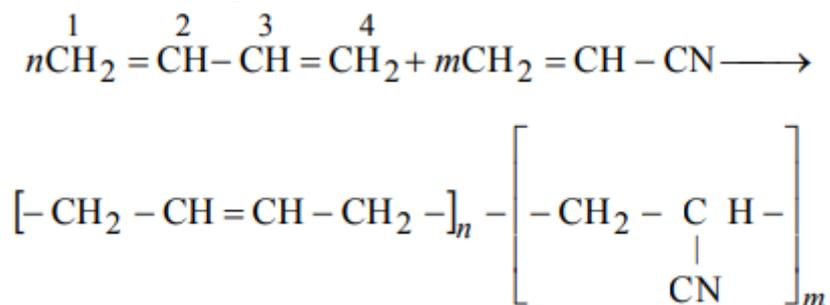
В результате совместной полимеризации бутадиена-1,3 и акрилонитрила получается бутадиеннитрильный каучук (СКН). Наличие в молекуле каучука полярной группы – C ≡ N обуславливает его стойкость к действию минеральных масел, бензина и других алифатических углеводородов.
