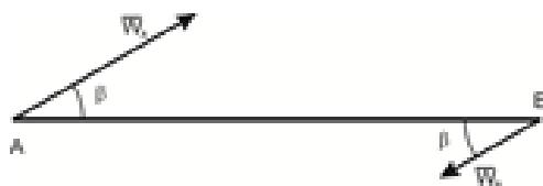
2. Ускорения концов  $A$  и  $B$  стержня длиной  $L$  параллельны между собой, направлены в противоположные стороны, составляют острые углы  $\beta$  со стержнем и имеют модули  $W_A$  и  $W_B$ . Определить угловую скорость и угловое ускорение стержня, а также его мгновенный центр ускорений.
