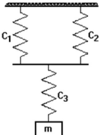
2. Определить круговую частоту свободных вертикальных колебаний груза массой  $m=2$  кг, если коэффициенты жесткости пружин  $C_1 = C_2 = C_3 = 300$  Н/м.
