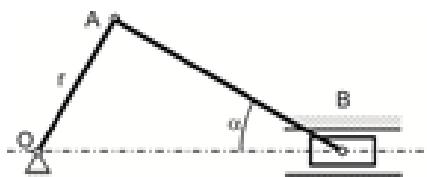
2. Определить модуль ускорения точки  $A$  в момент, когда мотыль  $OA$  и шатун  $AB$  взаимно перпендикулярны, а угол  $\alpha = 30^\circ$ , если при этом скорость поршня  $B$  имеет максимальное значение, равное  $v_0$ . Длина  $OA = r$ .
