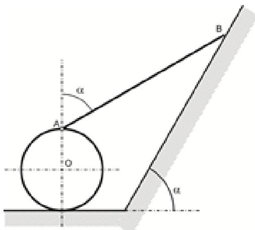
1. Конец  $B$  стержня  $AB$  скользит со скоростью  $V = 1 \text{ м/с}$  по наклонной плоскости. Другой конец  $A$ , шарнирно связан с роликом, который катится без скольжения. Определить скорость центра  $C$  ролика, если угол  $\alpha = 60^\circ$ .
