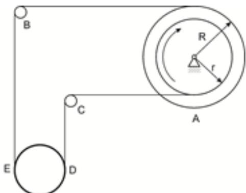
1. Подъем трубы производится с помощью ступенчатого барабана **A**, вал которого делает 10 об/мин. Определить модуль скорости оси трубы, если  $r = 5$  см,  $R = 15$  см. Участки тросов **BE** и **DC** считать вертикальными.
