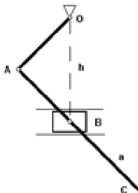
2. Ползун B движется равномерно в прямолинейных горизонтальных направляющих со скоростью  $v$  и приводит в движение стержень AC и балансир OA. Определить модули ускорений точек A и C в момент, когда точка B находится на одной вертикали с неподвижной точкой O, если в этот момент угол OAC =  $90^\circ$ . Длина кривошипа OA = R, расстояние от шарнира O до направляющих ползуна = h, расстояние BC = a.
