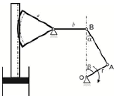
1. Поршень приводится в движение с помощью кривошипного механизма с зубчатой рейкой и зубчатым сегментом. Определить модуль скорости поршня в положении механизма, указанном на рисунке, если при этом  $\alpha = 30^\circ$ ,  $\beta = 60^\circ$ , а угловая скорость кривошипа равна  $\omega_0$ .
