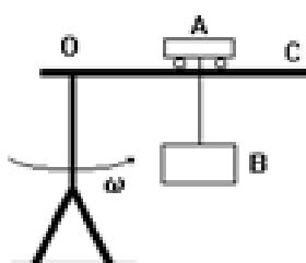
3. Башенный кран вращается равномерно с угловой скоростью 2 рад/с. Тележка A имеет в данный момент скорость  $v = 3 \text{ м/с}$  и ускорение  $w = 4 \text{ м/с}^2$  по отношению к стреле OC. Груз B опускается равномерно вертикально вниз. Чему равен модуль абсолютного ускорения груза в момент, когда расстояние OA = 3
