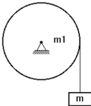
3. На однородный цилиндр, способный свободно вращаться вокруг горизонтальной оси, намотан трос, на свободном конце которого подвешен груз массой  $m$ . Определить давление на ось цилиндра, если груз опускается с ускорением  $w$ , масса цилиндра равна  $m_1$ .
