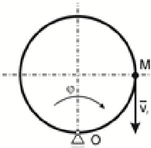
3. Диск вращается в своей плоскости вокруг точки  $O$  с некоторой постоянной угловой скоростью, а точка  $M$  разномерно движется по окружности диска, обходя его два раза за время одного оборота. Зная, что абсолютное ускорение точки  $M$  в момент, когда  $\phi = 90^\circ$ , равно  $\sqrt{82} \text{ м/с}^2$ , определить угловую скорость диска, если его радиус равен 1 м. Направления движения точки и вращения диска указаны на рисунке.
