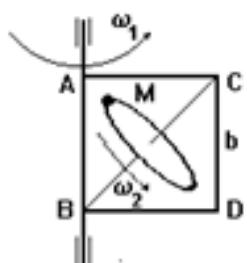
3. Квадратная рама со стороной  $b$  вращается вокруг оси **AB** с постоянной угловой скоростью  $\omega_1$ . Вокруг оси **BC**, совпадающей с диагональю рамы, вращается диск радиусом  $R = b\sqrt{2}/4$  с постоянной угловой скоростью  $\omega_2 = \omega_1\sqrt{2}$ . Определить модуль абсолютного ускорения точки **M** диска, лежащего в данный момент в плоскости рамы.
