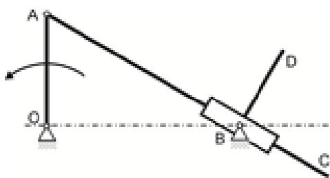
1. При вращении кривошипа  $OA$  механизма стержень  $AC$  благодаря наличию поворотной втулки все время проходит через неподвижную ложку  $B$ . С втулкой неизменно связан стержень  $BD$  длиной  $l$ , перпендикулярный стержню  $AC$ . Определить скорость точки  $D$  в момент, когда угол  $\angle AOB = 90^\circ$ , угол  $\angle ABO = 30^\circ$ , а угловая скорость кривошипа равна  $\omega_0$ .
