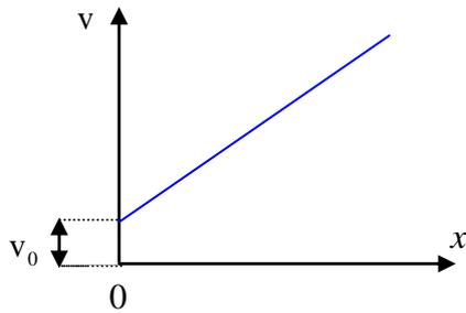
7. Скорость точки, движущейся прямолинейно, растет по линейному закону  $v = v_0 + kx$ . Как при этом изменяется ускорение?
