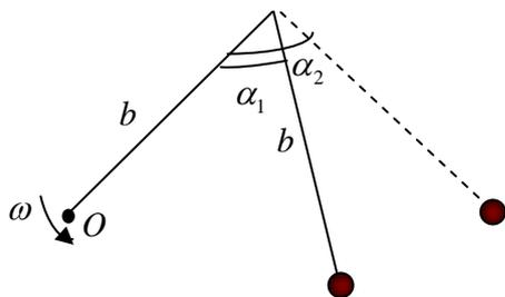
27. Два невесомых стержня длины  $b$  соединены под углом  $\alpha_1 = 60^\circ$  и вращаются без трения в горизонтальной плоскости вокруг вертикальной оси  $O$  с угловой скоростью  $\omega$ . На конце одного из стержней прикреплен очень маленький массивный шарик. В некоторый момент времени угол между стержнями самопроизвольно увеличился до  $\alpha_2 = 90^\circ$ . Система стала вращаться с угловой скоростью
