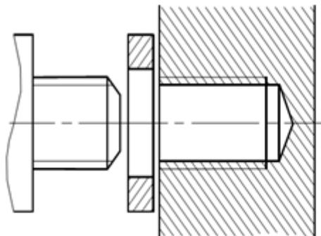
3. Вычертите детали в сборке. Обозначьте резьбу, если она метрическая, наружный диаметр 32 мм, с мелким шагом 1,5 мм, левая.
