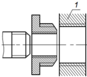
3. Вычертите детали в сборке. На детали 1 обозначьте резьбу, если она трубная 1/4".
